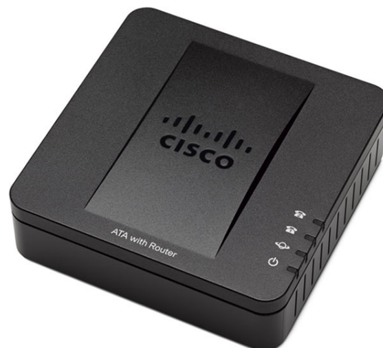
▲ Cisco SPA112 to niedroga, ale funkcjonalna bramka VoIP wyposażona w dwa porty FXS do podłączenia dwóch niezależnych telefonów przewodowych lub bezprzewodowych.
